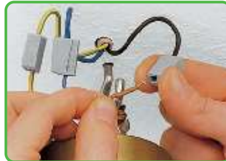
Отключение: нажать кнопку и извлечь проводник.
