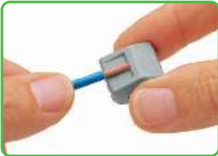
Снимите изоляцию проводника на длине 9 – 10 мм
