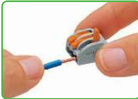
Подключение проводника: откройте отверстие зажима с помощью рычага и вставьте проводник . . .
